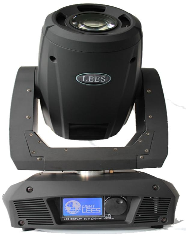
ILESBH350 **LESS-Big-HERO 350** Proyector Spot móvil con lámpara Philips MSD R17 350W, temperatura de color 8.000 K, óptica de alta precisión de 0°-7° modo Beam, 5°-40° modo Spot, rueda de 12 rotating gobos intercambiables+B, rueda de 17 gobos+B, rueda 13 colores+B, prisma rotativo 8 y 24 caras +16 macro, iris 5%-10% con efecto, focus motorizado, frost filter, Pan 540°-Tilt 250°, estrobo 0-13 Hz, modo DMX, autónomo, master-esclavo, peso 21 k, medidas 370x300x5500 mm, consumo 500W. 2.020,00
