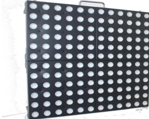
IESPPIXEL **Pixel Light Matriz** con 144 LED RGMW, 4-1, de 1 de 1,5 W, permite generar efectos locos de grafismo, control individual, 7/151/432 canales DMX, Art-net, conectores Powercom in-out, peso 7 kg, medidas 500x500x72 mm , consumo 220 W. 1.265,00
