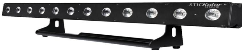
ISW190995 **STICKOLOR** Barra equipada con 12 LEDs de 10W RGBAW+UV 6 en 1, apertura 50°, equipada con dimmer, RDM, DMX, conectores señal XLR 3 y 5 pin, conectores de red Powercom macho y hembra chasis, peso 6,2 kg y medidas 900x140x150 mm, consumo 145 W. 595,00
