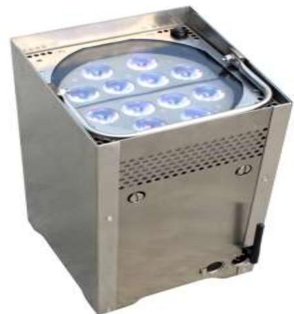
ISW900290 **EventKolor MK2** Proyector de leds autónomo total con batería con 12 LEDs RGB SMD de 3 W, 800 lumens, ideal para arquitectural, abertura 16°, angulación cada dos modulo de 6 LEDs, autonomía de 8 horas al 100% en color blanco y 12 horas en RGB, IP 44, 12 canales DMX con wireless, peso 16,5 kg, medidas 202x202x364 mm, consumo 45 W. 905,00
