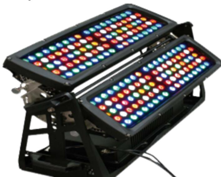
ISW900090 **CityKolor** Proyector de leds con 180 LEDs RGB + blanco + ámbar, 44 rojos, 44 verdes, 44 azules, 24 ámbar, 24 blancos generando 18.000 lm similar a lámpara MSR 2500, abertura 15°, opcional 30°/55°/25x 6°, IP 67, Strobo 0-20 Hz, 3/17 canales DMX, compatible Wireless solutions, flight case incluido, peso 35 kg, medidas 719x252x563 mm, consumo 680 W. 4.460,00
