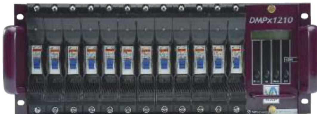
ISW430630 **DMPX 1210** Dimmer de 12 canales de 10 A por canal, cada canal y CPU modular, protección magneto térmica consultar con led por canal, display con menú con control local, direccionamiento de cada canal individual, 3 curvas, memorización 12 escenas en modo autónomo o por falta de DMX, patch individual....Formato rack 3U, salida por canal a bornas, conectores de señal DMX con XLR 3, 0+10 v con sub D 15. Peso 27 kg, medidas 483x475x177 mm.
