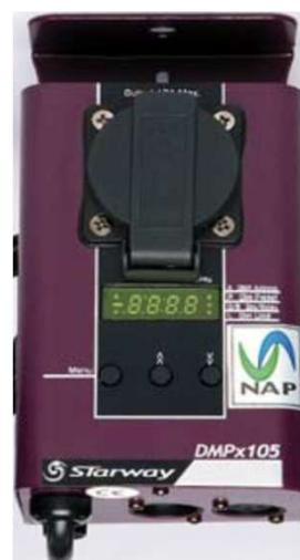
ISW432120 **DMPX 105** Dimmer de 1 canal de 5 A con precalentamiento ajustable, conector schucho francés, display , ventilación por convección, DMX, peso 1,1 kg, medidas 182x92x65 mm.
