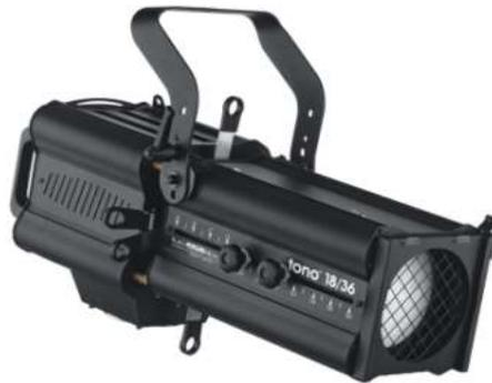
ILDR10903030 **Tono 18/36** recorte de 2.000w construido en aluminio y acero, con doble lente condensadora y óptica zoom. Distancia de trabajo 6 a 23 mts., Portalamp. GY16, cuerpo de cuchillas giratorio, tamaño de gobo A/B, interruptor de desconexión al acceder a la lamp. , 2 mts de manguera de 3x2.5 mm, incluida la lamp., asa para el transporte, 4 cuchillas, rejilla de seguridad y porta gelatinas de 185x185 mm. Peso 14 Kg, medidas 720x310x500 mm. 1.098,05
