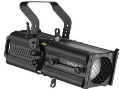
ILDR10853020 **Nota 8/22** recorte de 1.200w construido en aluminio y acero, con doble lente condensadora y óptica zoom. Distancia de trabajo 5 a 25 mts., Portalamp. GX9.5, cuerpo de cuchillas giratorio, tamaño de gobo A/B, interruptor de desconexión al acceder a la lamp. , 2 mts de manguera de 3x1.5 mm, incluida la lamp., asa para el transporte, 4 cuchillas, rejilla de seguridad y porta gelatinas de 185x185 mm. Peso 14.3 Kg, medidas 870x300x420 mm. 882,55
