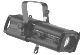
ILDR10604020 **Suono 10/28 plus** recorte de 650w construido en aluminio y acero, con doble lente condensadora y óptica zoom. Distancia de trabajo 2 a 15 m. Portalamp. GY9.5, cuerpo de cuchillas giratorio, interruptor de desconexión al acceder a la lamp. , 1,5 mts de manguera de 3x1.5 mm, incluida la lamp., asa para el transporte, 4 cuchillas, rejilla de seguridad y porta gelatinas de 125x125 mm. Peso 7,5 Kg, medidas 640x240x300 mm. 517,84
