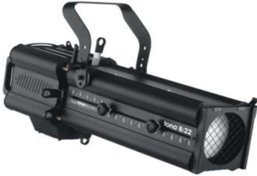
ILDR10903020 **Tono 8/22** recorte de 2.000w construido en aluminio y acero, con doble lente condensadora y óptica zoom. Distancia de trabajo 6 a 30 mts., Portalamp. GY16, cuerpo de cuchillas giratorio, tamaño de gobo A/B, interruptor de desconexión al acceder a la lamp. , 2 mts de manguera de 3x2.5 mm, incluida la lamp., asa para el transporte, 4 cuchillas, rejilla de seguridad y porta gelatinas de 185x185 mm. Peso 14,7 Kg, medidas 901x310x500 mm. 1.098,05
