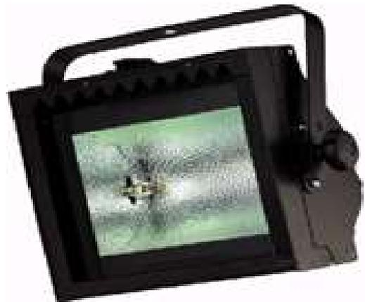
ILDR10806050 **Inno A1000** panorama 1.000w asimétrico construido en acero, puerta de acceso a la lamp. con cristal anti calórico e interruptor de desconexión. Distancia de trabajo 0 a 10 m. Portalamp. R7s 189 mm, incluida la lamp., 1.5 m manguera 3x1.5 mm y porta gelatinas de 290 x 270 mm, peso 5.3 Kg, medidas 390 mm largo x 165 mm ancho x 280 mm de alto. 236,79
