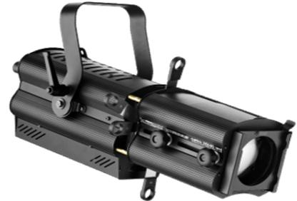
ILD1104020 **Cetra 10/28** recorte de LEDs de 100w, zoom de 10° a 28°, temperatura de color 3.200°K o 5.600°K, con doble lente condensadora, control DMX, RDM o manual, conectores powercon macho y hembra, peso 9,2 Kg, medidas 730x240x300 mm, consumo 100 W. 1.517,84
