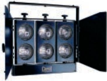
Los MiniBruts se ofrecen en diferentes configuraciones para el uso de lámparas halógenas Par 36 650w. Luminarias robustas y livianas, construidos en chapa de acero y aluminio, con una resistente horquilla. Cada barra vertical de lámparas tiene movimientos independientes que permite modificar el ángulo de luz. Suministrado con viseras e interruptores.
